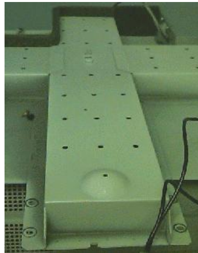
Gambar 8. Waveguide dalam Microwave oven (Febrian et al. , 2011)
