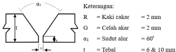
Gambar 13. Dimensi Kampuh dengan Alur V Tunggal
