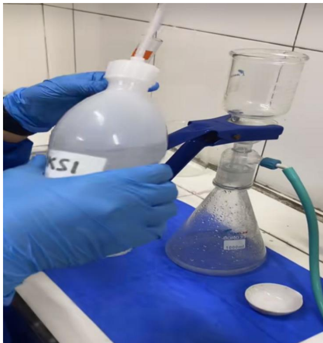
Gambar 12. Ilustrasi Proses Penyaringan Sampel Air
