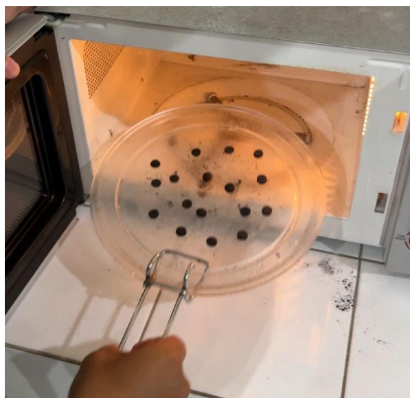
Gambar 3.14 Proses Aktivasi Fisik Filter Arang Bambu
