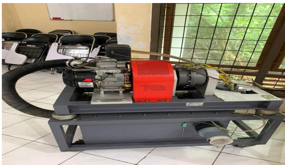
Gambar 3.1 Mesin Bensin TD200
