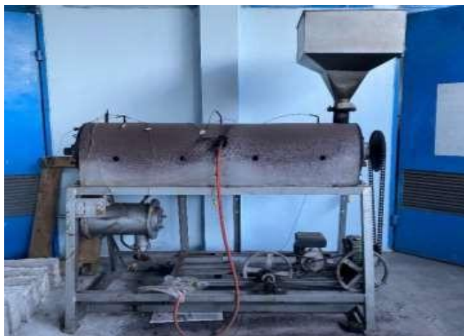
Gambar 2. Reaktor Torefaksi Kontinu Tipe Tubular dengan Sistem Pemanas Oil Jacket .
