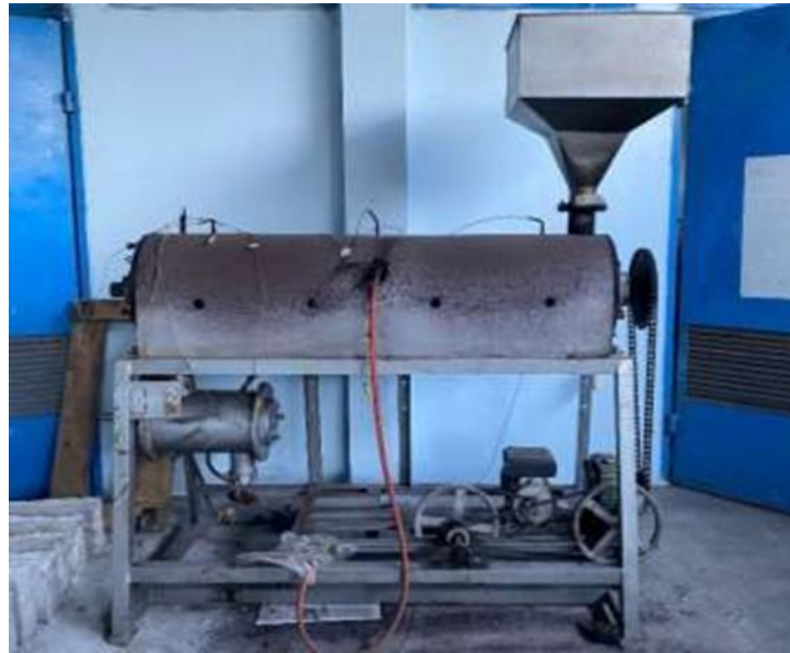
Gambar 3.1 Reaktor Torefaksi Kontinu Tipe Tubular dengan Sistem Pemanas Oil Jacket
