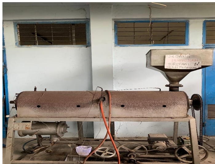
Gambar 3. 1 Reaktor Torefaksi Kontinu Tipe Tubular dengan Sistem Pemanas Oil Jacket
