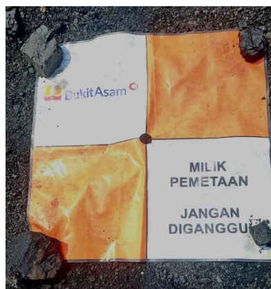
Gambar 11 Premark (Sumber : Survey lapangan,2025).
