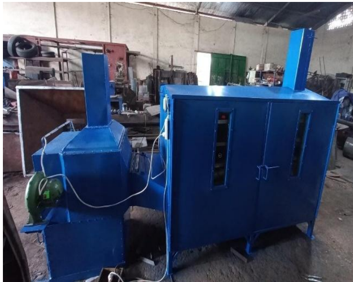
Gambar 3. 8 Pengeringan bed dryer berbasis tungku pembakaran biomassa.
