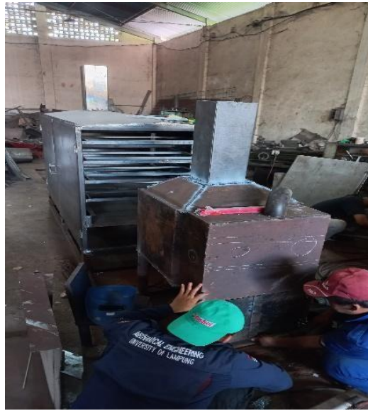
Gambar 3. 7 Proses pembuatan tungku dan penggabungan dengan ruang pengering.
