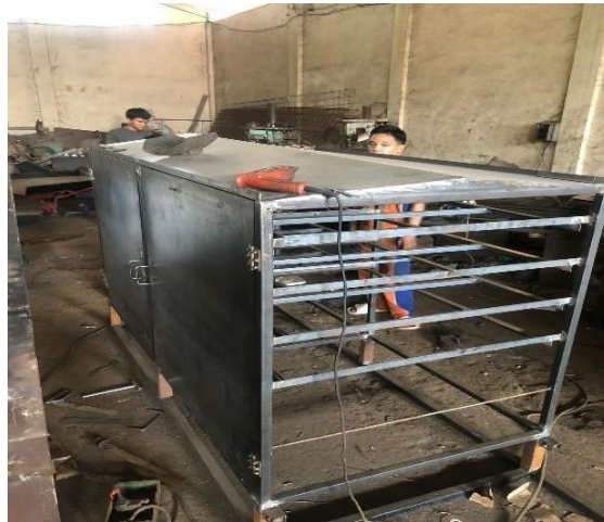
Gambar 3. 5 Proses penempelan dinding pengering ke rangka.
