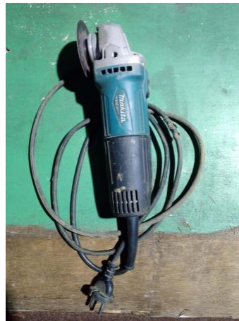
Gambar 3.1 Mesin Gerinda Potong
