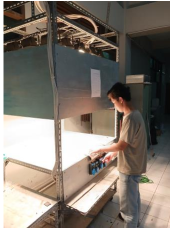
Gambar 3.25 Mengatur Intensitas Solar Simulator
