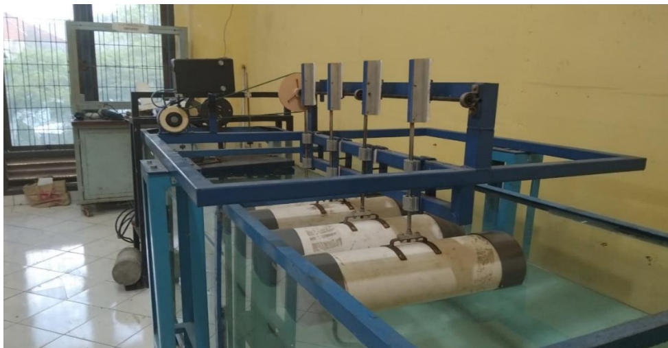
Gambar 3.8 Model alat pembangkit listrik tenaga gelombang laut
