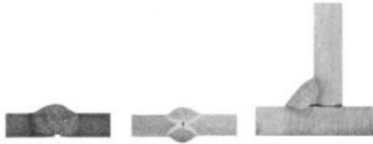
Gambar 16. Penetrasi yang kurang sempurna
