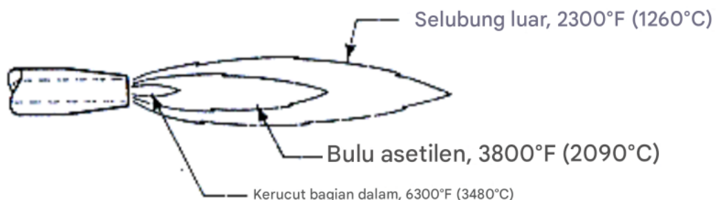
Gambar 3. Nyala oksidasi-asetilena pada setiap temperatur yang dicapai (Siswanto, 2018)
