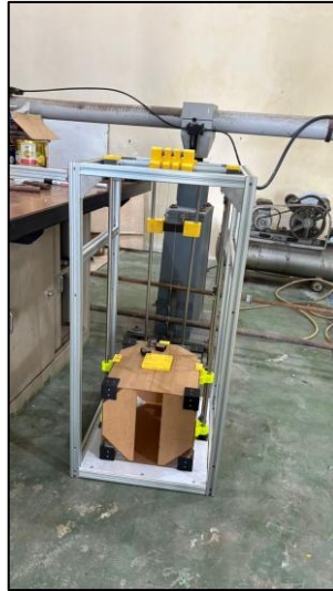
Gambar 26 Hasil dari Perakitan Sistem Lift
