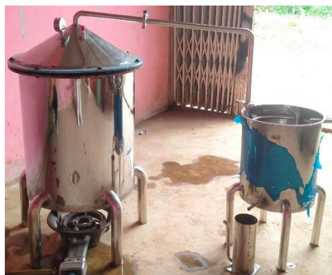
Gambar 3. Alat penyulingan dengan air dan uap Sumber : Dokumentasi pribadi
