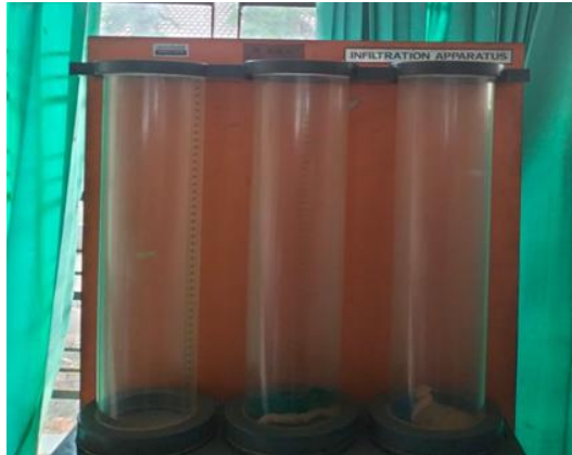
Gambar 5. Alat pengukur infiltrasi ( infiltrasi apparatus )
