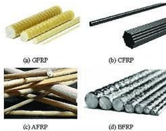
Gambar 1. Jenis-Jenis FRP Bars (Sumber: Shakir Abbood et al., 2021)
