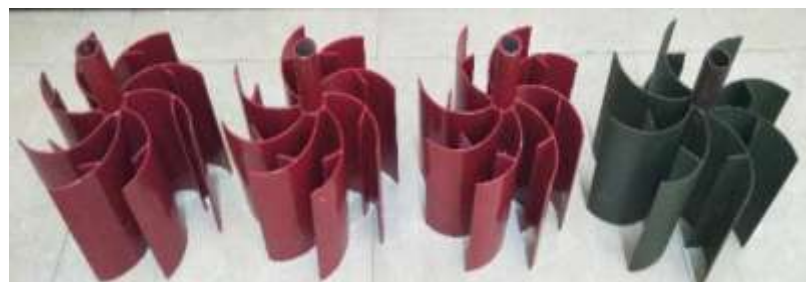
Gambar 7. Sudu turbin Vortex berpenampang silinder
