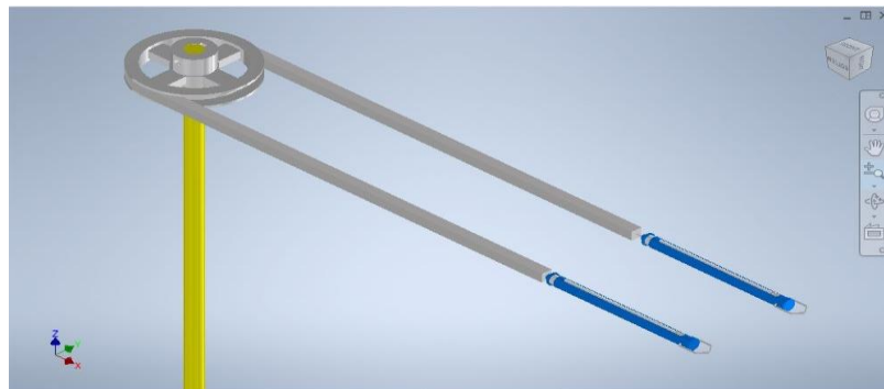
Gambar 3. 24 Skema pengukuran torsi F 2 dan F 1
