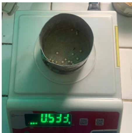
Gambar 13. Penimbangan bobot kadar air benih sorgum.
