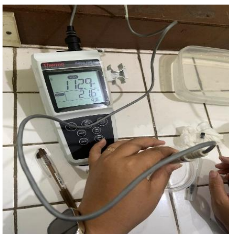
Gambar 14. Pengukuran daya hantar listrik pada air rendaman benih sorgum.
