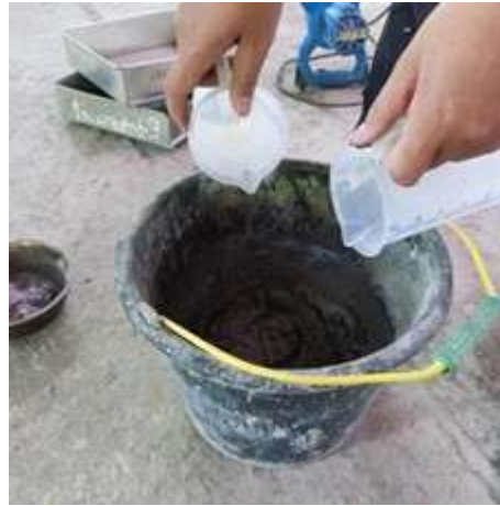
Gambar 3.18. Menambahkan serat polypropylene , air, dan superplasticizer .
