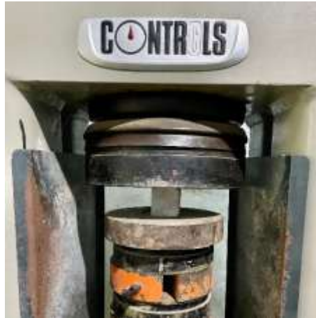
Gambar 3.26. Uji kuat tekan mortar.
