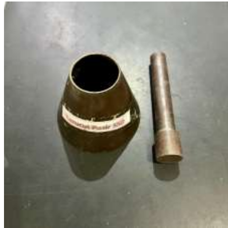
Gambar 3.9. Cetakan kerucut pasir.
