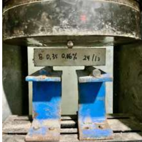
Gambar 3.27. Pengujian kuat lentur mortar.
