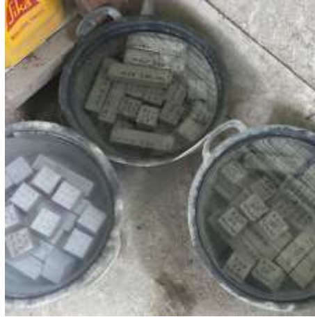
Gambar 3.25. Perawatan benda uji ( curing ).
