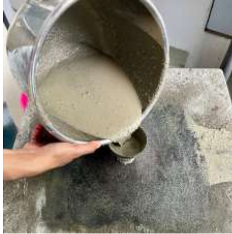
Gambar 3.20. Memasukkan campuran mortar.
