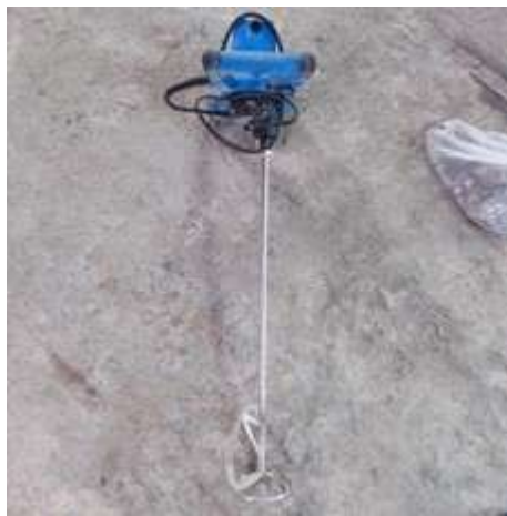
Gambar 3.11. Mesin pengaduk mortar.
