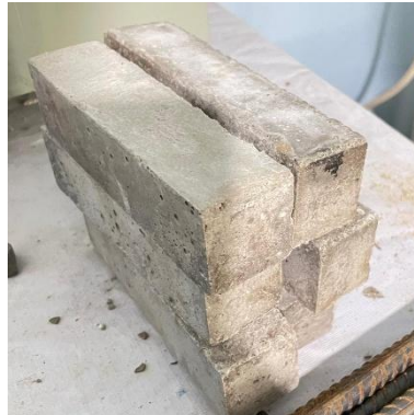
Gambar 33. Membuka cetakan mortar.
