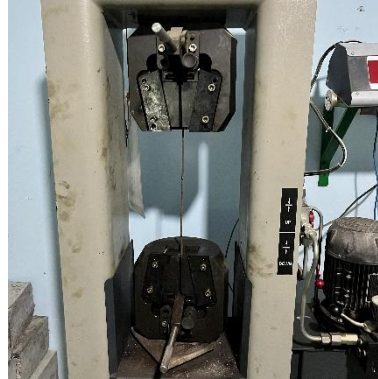
Gambar 43. Pengujian kuat tarik tulangan.
