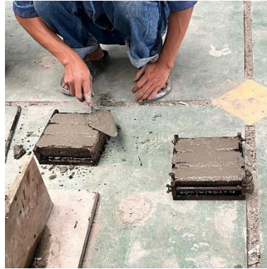
Gambar 32. Memasukkan campuran mortar kedalam cetakan.
