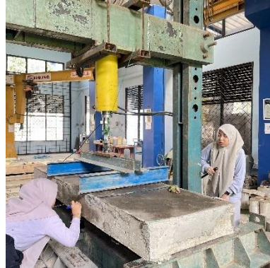
Gambar 48. Menambahkan beban secara bertahap dan konstan.
