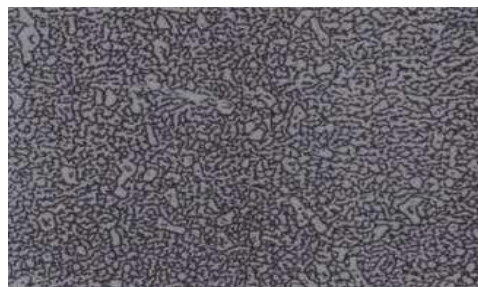
Gambar 2. 6 Struktur Mikro Fasa Sementit
